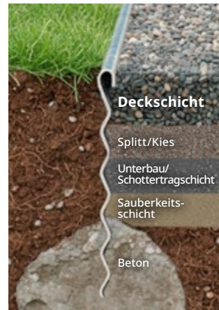
Das Gartenprofil verankert sich im Betonfundament
