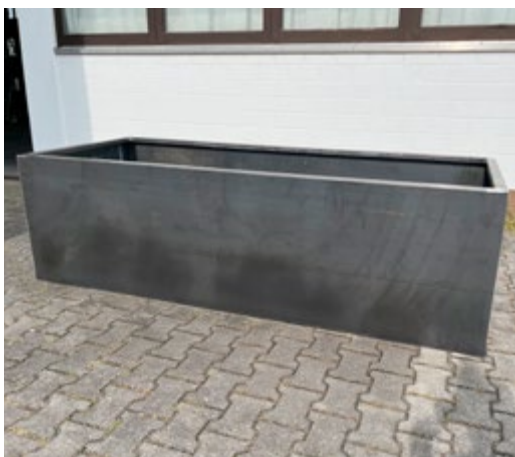
Cortenstahl S355 Auslieferungszustand
